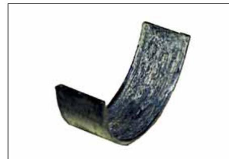
**Так будет выглядеть шатунный вкладыш коленчатого вала после запуска двигателя в сильный мороз на загустевшем летнем масле.**
