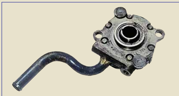
Насос гидроусилителя руля оригинальной конструкции — привод осуществляется передним хвостовиком коленчатого вала.
