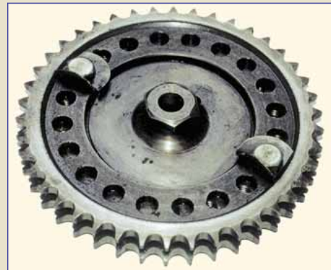
Такая звездочка позволяет точно установить фазы газораспределения.
