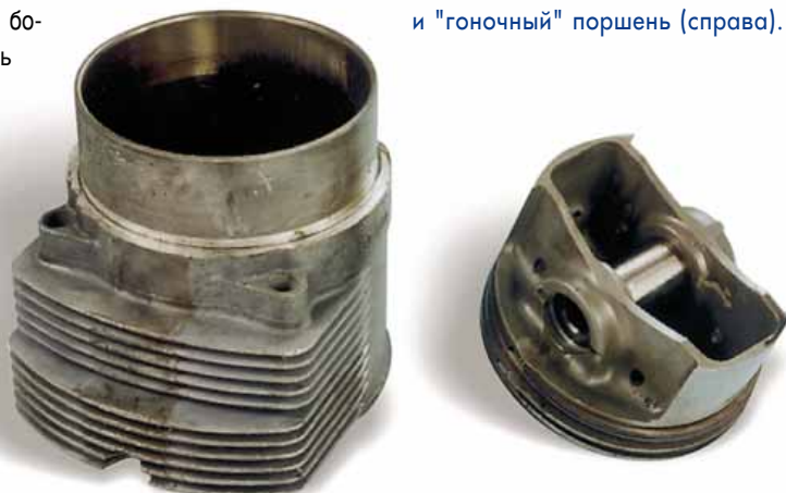
Типично "авиационный" цилиндр (слева) и "гоночный" поршень (справа).
