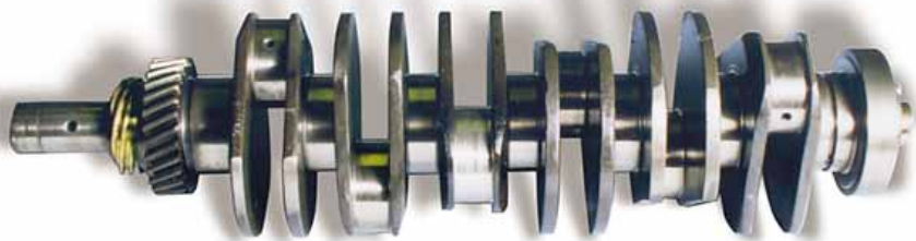
У коленчатого вала удивительно тонкие противовесы и узкие шейки.
