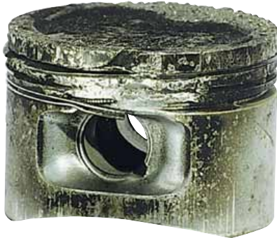
б) начало плавления поврежденного поршня;
