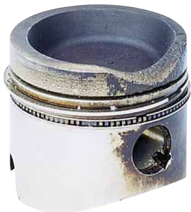
А на этом поршне детонация выжгла хороший кусок — результат отказа регулятора давления турбонаддува.
