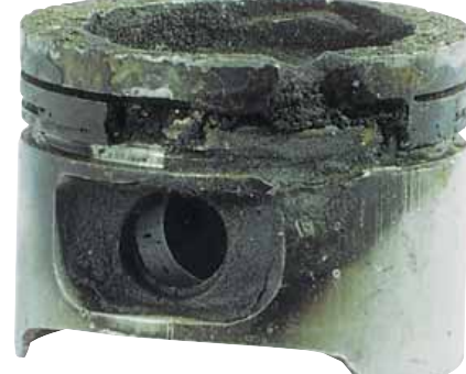
в) прогар верхнего уплотнительного пояса поршня.
