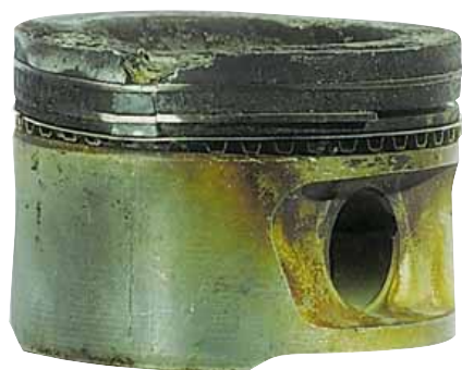
а) деформация перемычек и колец из-за перегрева;
