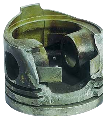
Сильная детонация в конечном счете привела к поломке юбки поршня.
