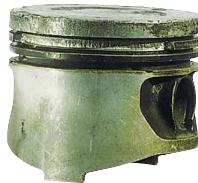
Поломанная перемычка на поршне — типичный результат детонации.
