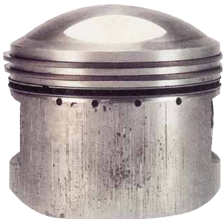
Плохая фильтрация масла послужила причиной абразивного износа юбки, цилиндра и поршневых колец.
