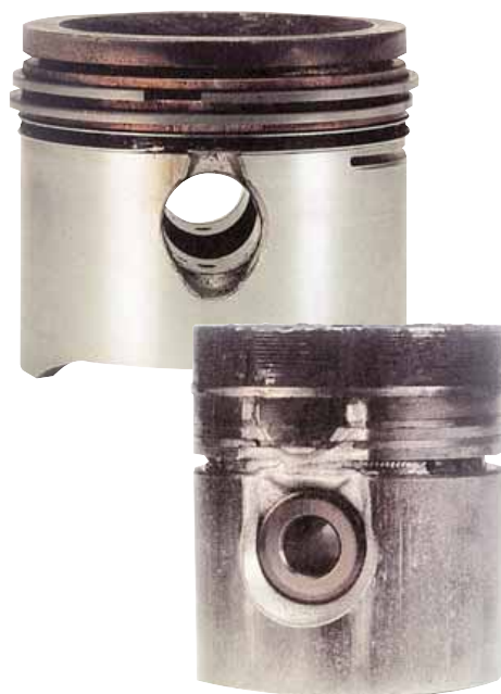
Выскакивание стопорного кольца поршневого пальца ведет к повреждению поршня у отверстия. При этом в цилиндре наблюдаются глубокие борозды от пальца.
