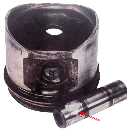
Схватывание пальца в отверстии бобышек поршня произошло сразу после запуска двигателя. Причина — малый зазор в соединении и недостаточная смазка.
