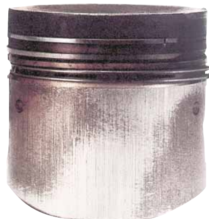
Деформированный шатун обычно приводит к несимметричному пятну контакта юбки с цилиндром из-за перегиба поршня.
