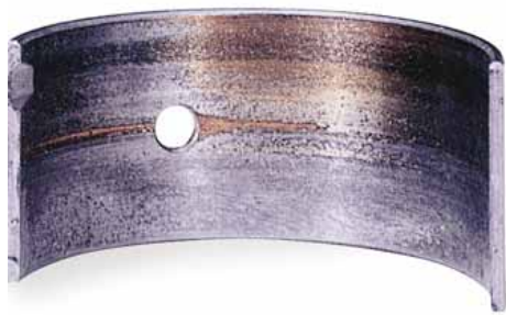
Абразивный износ вкладышей легко установить по матовой рабочей поверхности, рискам и стиранию верхнего слоя.
