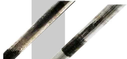
Когда смазка стержня клапана в направляющей втулке недостаточна, образуется задир с наволакиванием и взаимным переносом материалов.
