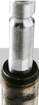
**Износ стержня — следствие неправильного монтажного зазора во втулке или оставшейся после притирки абразивной пасты.**
