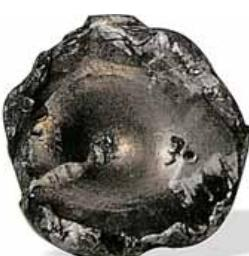
**Поломка клапана от больших механических перегрузок.** Причиной могут стать большой зазор в приводе, заклинивание клапана, превышение максимальной частоты вращения, разрушение пружины, деформация стержня или несоосность седла с направляющей втулкой.
