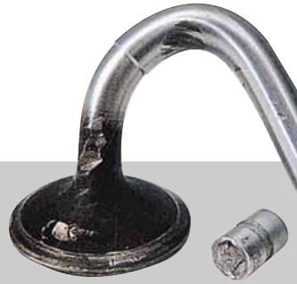
Разрушение по пазу сухаря может случиться из-за неправильной разборки и сборки клапана, а также вследствие больших зазоров в приводе.
