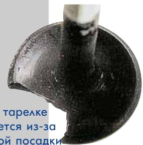
Скол на тарелке образуется из-за неплотной посадки в седле, ударных нагрузок или ненормального горения топлива.
