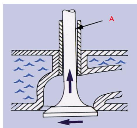
Когда масло легко проникает через зазор между стержнем и направляющей втулкой, тарелка клапана быстро покрывается нагаром.
