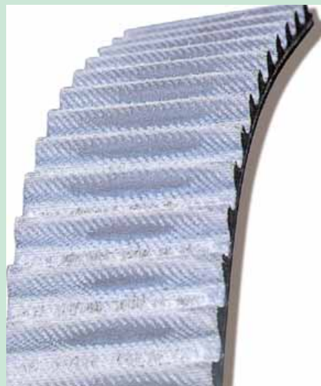
Износ рабочей поверхности зубьев — следствие неправильного натяжения ремня.
