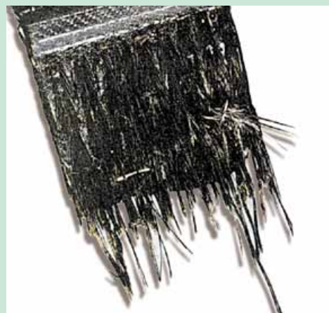
Обрыв из-за потери адгезии (прочности соединения) различных слоев ремня. Обычно возникает из-за длительного воздействия масла или топлива.
