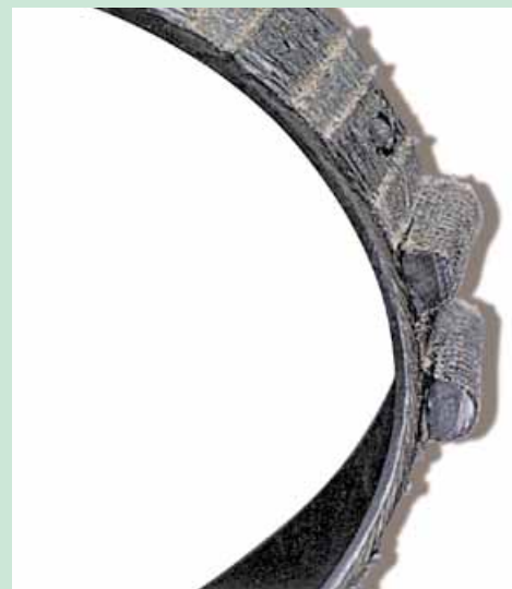
Типичная причина срезания зубьев ремня — заклинивание ведомого вала.
