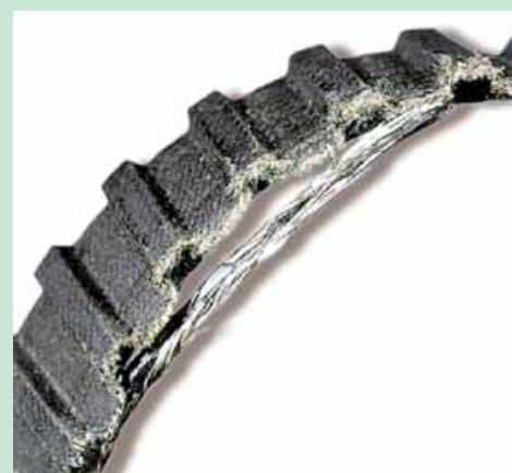
Износ впадин зубьев из-за чрезмерного натяжения или износа шкивов.
