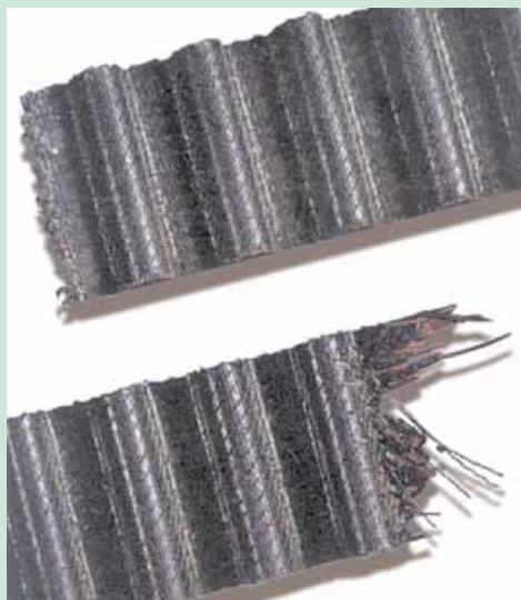
Подобный обрыв ремня, как правило, связан с чрезмерным натяжением или резким перегибом ремня перед установкой.
