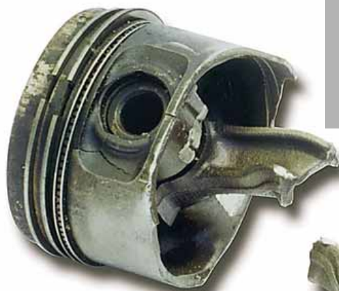
Поработав немного после гидроудара, деформированный шатун сломался пополам (а). На бобышках поршня видны вмятины и трещина от ударов противовесов коленвала в НМТ (б).
