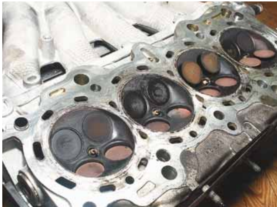
Идеальное состояние поверхности камер сгорания, клапанов и изоляторов свечей зажигания указывает на то, что двигатель продолжительное время работал на газе. Состояние головки можно было бы назвать отличным, если бы не одно «но»....
