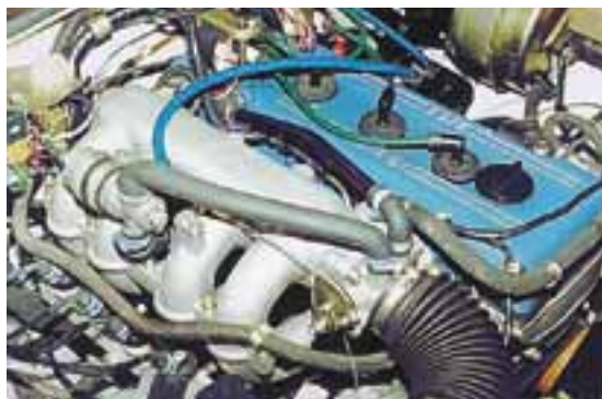
Вряд ли в ближайшем будущем двигатель ЗМЗ-4062.10 сможет удовлетворить европейским экологическим нормам. Применение газового топлива (в данном случае сжатого природного газа) помогает и снизить токсичность выхлопа, и сэкономить.
