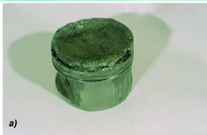
Прогар поршня после длительной работы изношенного двигателя на максимальных режимах: а) бензиновый двигатель
