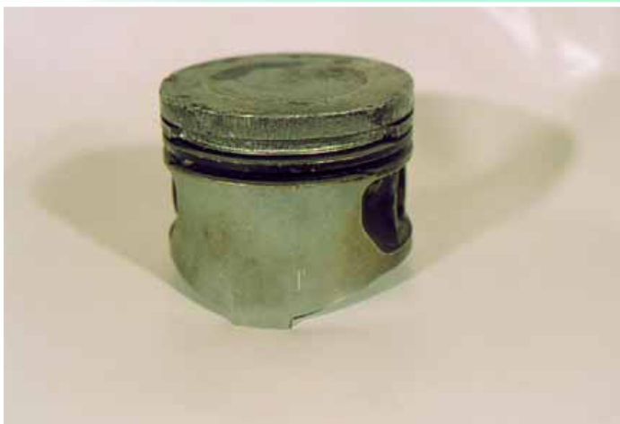
Поломка перемычек поршня — результат работы двигателя с детонацией
