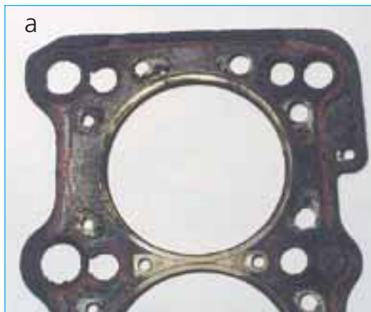
Типичные последствия перегрева двигателя: а) прогар прокладки ГБЦ; б) задиры на поршне и поршневых кольцах.
