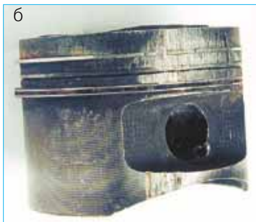
Типичные последствия перегрева двигателя: а) прогар прокладки ГБЦ; б) задиры на поршне и поршневых кольцах.
