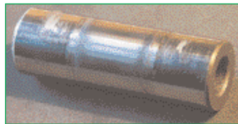
Поврежденный палец, задиры на нем были причиной стука.
