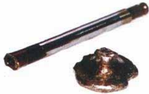
Поломанный выпускной клапан. Его тарелка нашлась в поддоне — классический случай разрушения
