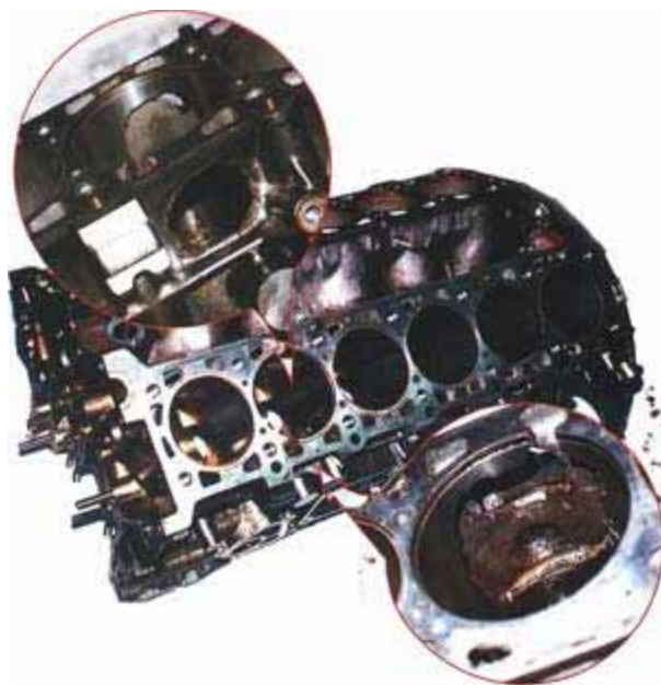
Блок цилиндров V12 — произведение автомобильного искусства — пробит так, что лучше его не восстанавливать
