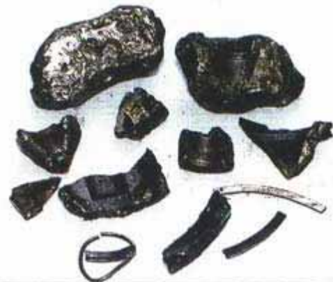
Все, что осталось от поршня, принявшего на себя главный удар оторвавшейся тарелки клапана
