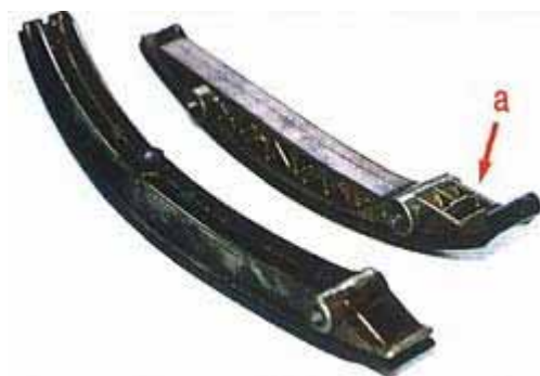
Старые успокоители и бабмаки — экономия на них была роковой ошибкой. Поломанный зуб защелки (а) свидетельствует о неудавшейся попытке заменить пластиковую накладку
