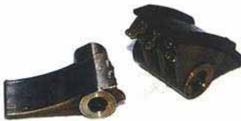
Виновник поломки двигателя — сломанный успокоитель цепи
