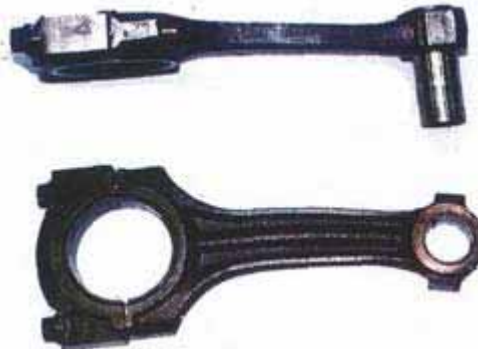
Шатун, проломив блок насквозь, несколько «потерял внешний вид»
