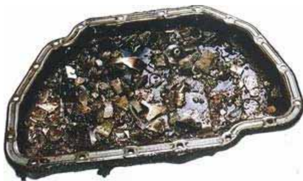
Количество металла в поддоне свидетельствует о серьезной поломке в двигателе
