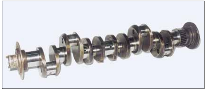
Коленчатый вал мотора M18 имеет вполне современный дизайн.
