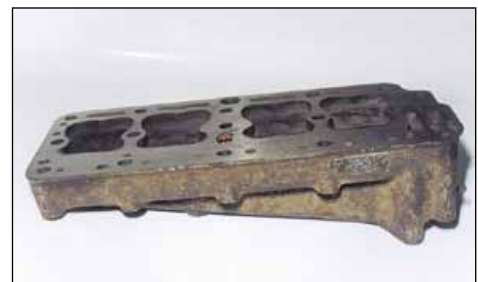
Форма головки блока очень проста — кроме свечей зажигания в ней ничего нет.
