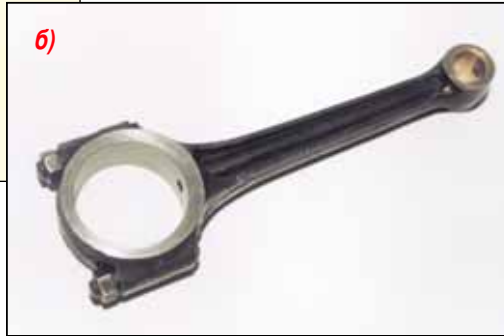
«Родной» (а) шатун двигателя М18 после ремонта (б) мало отличается от шатунов современных двигателей.
