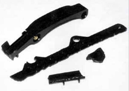
**Неисправный натяжитель привел к разрушению направляющих цепи.**
