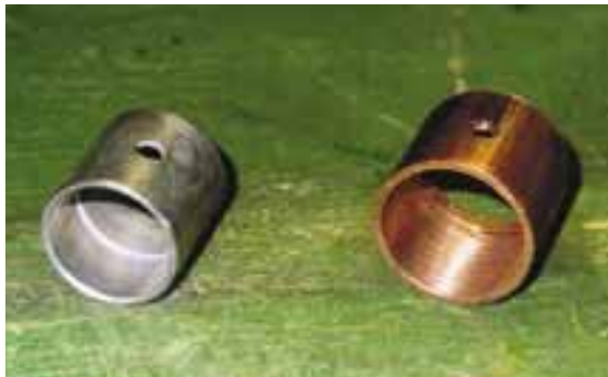
Равноценную замену фирменным втулкам верхней головки шатуна можно выточить из бронзы.
