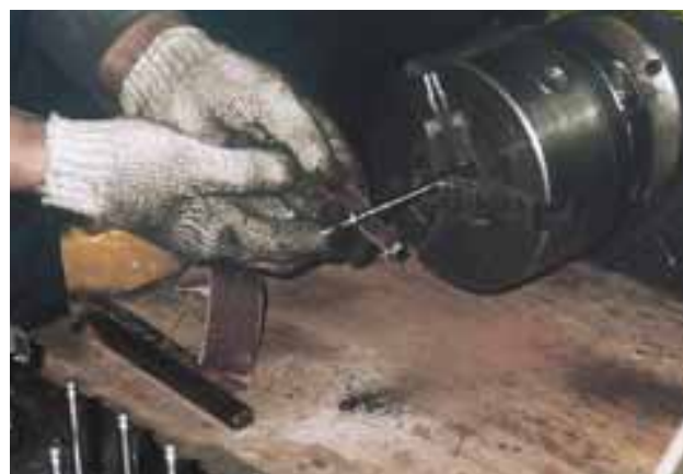
Доводочные операции также можно выполнить на токарном станке.
