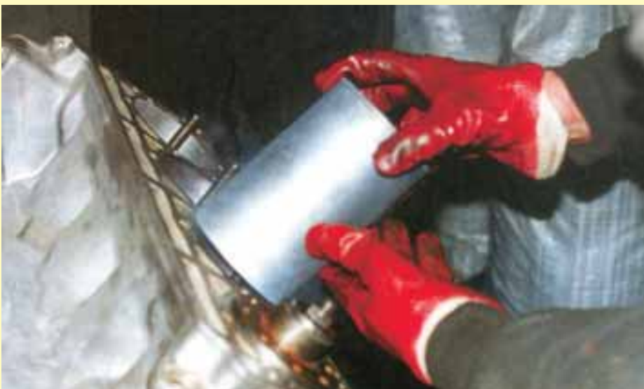
Гильзовка блока — самая ответственная операция. Она часто применяется при ремонте неремонтируемых моторов. Основной дефект — просадка гильз — прямое следствие скоростных и недорогих методов работы.
