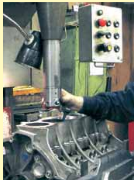
Можно было бы обойтись и без расточки, только такой двигатель, отремонтированный по упрощенно-удешевленной технологии, потом не «ходит».
