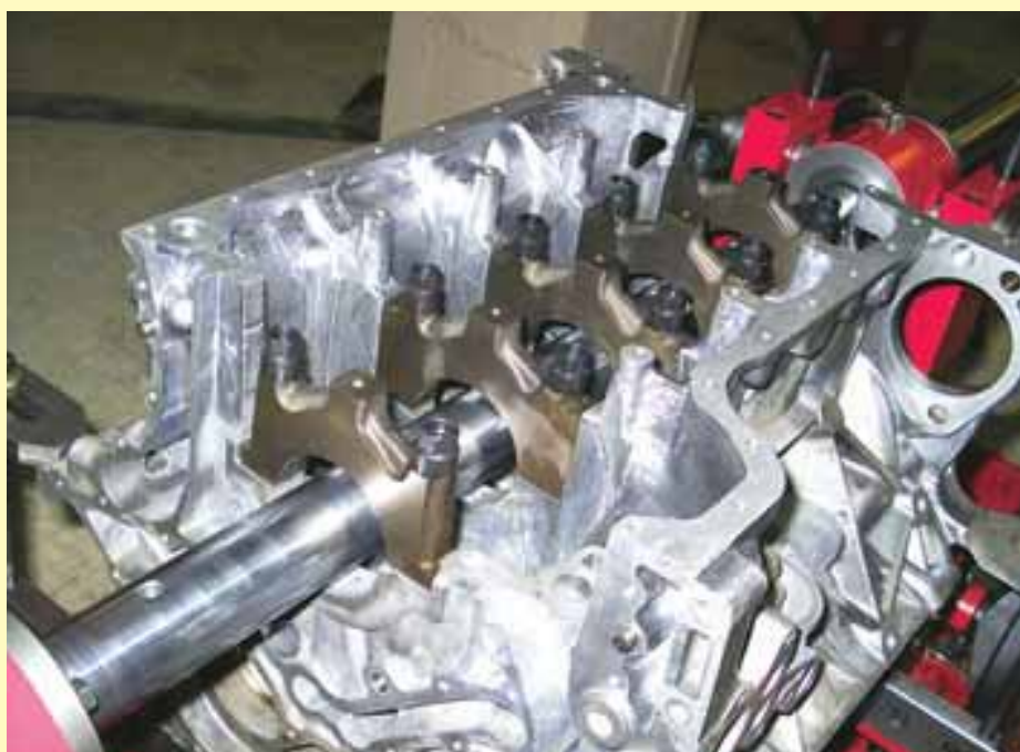
Расточка постелей — одна из самых ответственных процедур. Достаточно сделать ее по-быстрому, чтобы обречь мотор на быструю, но мучительную кончину.
