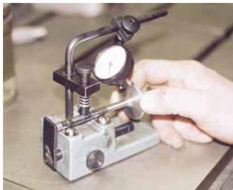
Проверка клапана на биение фаски — операция обязательная.
