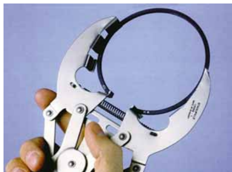
Для установки колец на поршень лучше всего пользоваться специальными клещами.
