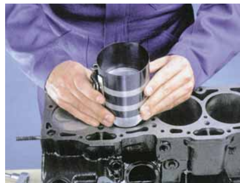
Вставлять поршни в сборе с кольцами и шатунами в цилиндр удобно с помощью ленточной оправки.
