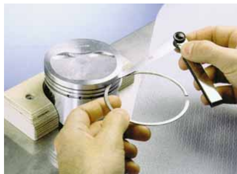
Повышенный зазор в канавке поршня — верная причина большого расхода масла.
