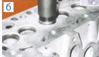
Установка нового седла выполняется с помощью оправки (а) ударным способом (б).
