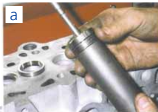
Установка нового седла выполняется с помощью оправки (а) ударным способом (б).
