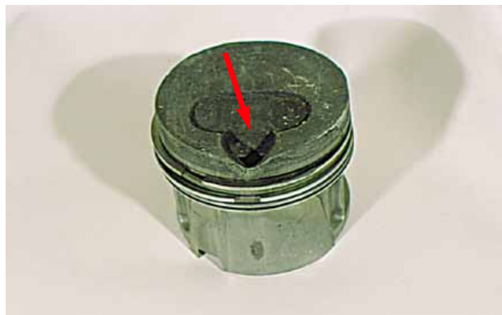
Дефект распылителя привел к прогару поршня.
