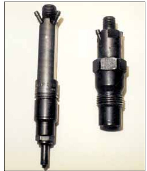
Форсунки дизелей VW последнего поколения (слева) существенно отличаются от форсунок, устанавливавшихся на двигателях прошлых лет (справа).
