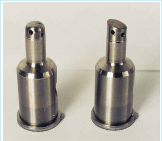
Форкамеры от более новых двигателей Mercedes (слева) не взаимозаменяемы с форкамерами старого образца (справа).
