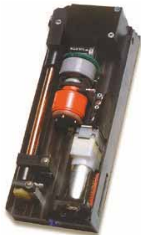
Измерительный блок американской фирмы Andros, несмотря на небольшие размеры, содержит все необходимое для определения концентрации пяти компонентов выхлопа: спектрометрический узел и два электрохимических датчика с платой питания. Размеры миниатюрные, а стоимость, как у большого!
