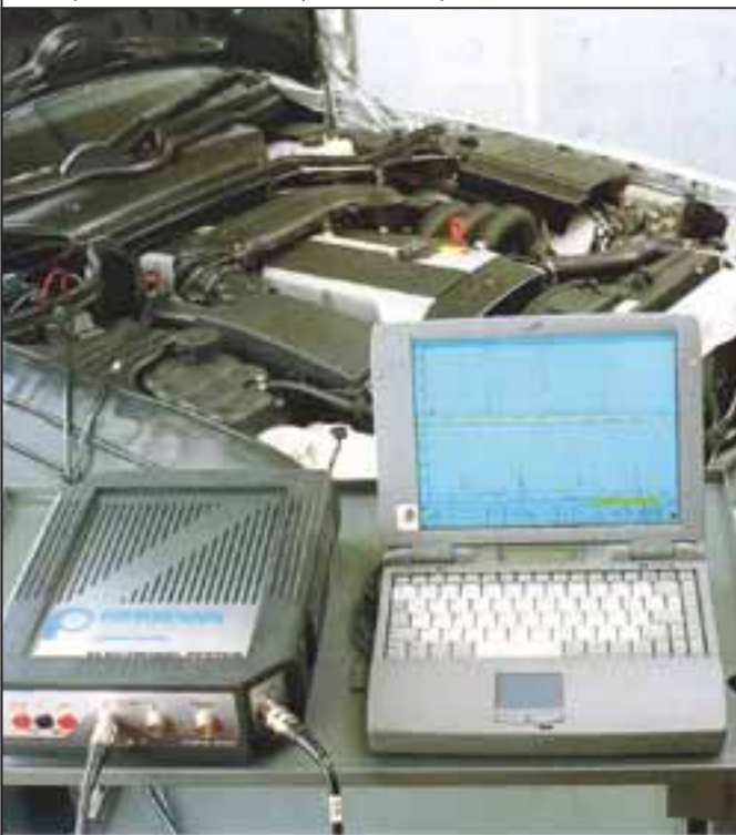
Мотортестер немецкой фирмы Hermann модели HMS 990 также может использоваться как в составе «кабинета» (передвижной стойки), так и в переносном варианте с питанием от АКБ автомобиля. Программный продукт содержит иллюстрированную базу данных с технической информацией, регулировочными данными, электросхемами, имеет режим «Help».
