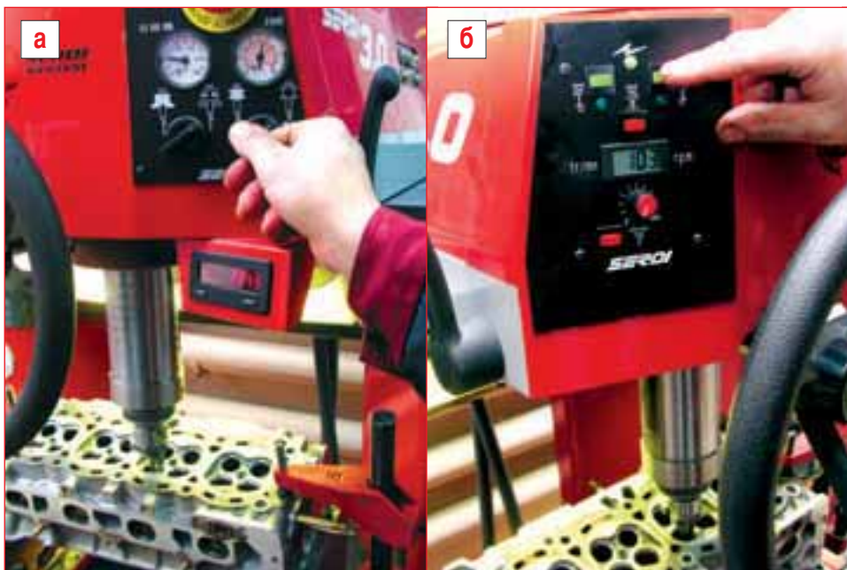
Достаточно попасть пилотом в отверстие направляющей втулки, включить на несколько секунд сферическую и малую плоскую воздушные подушки (а), затем установить скорость вращения шпинделя (б), чтобы начать обработку седла (в).
