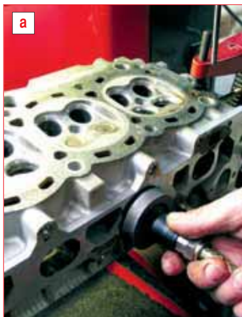
Для контроля плотности посадки клапана в седле служит вакуумтестер — необходимо установить клапан на место, поднести к отверстию канала насадку (а) и прочитать показания прибора (б).
