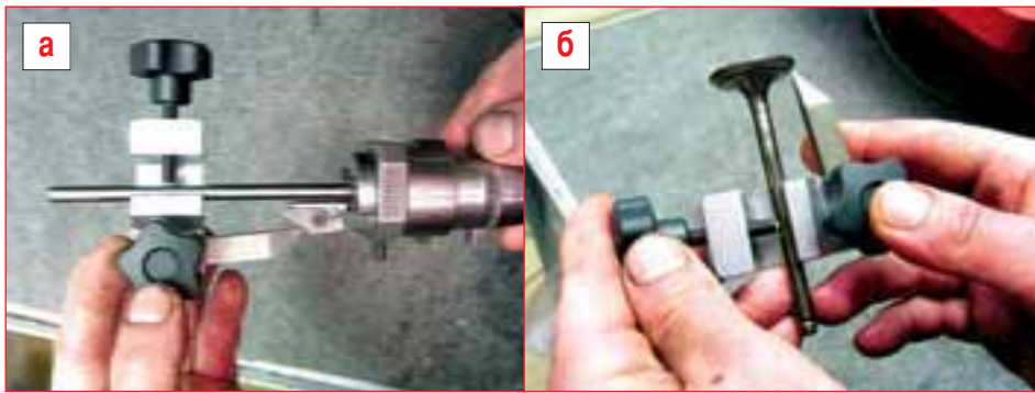
Вылет резца (а) в станках SERDI регулируется с помощью простого приспособления, предварительно настраиваемого по тарелке клапана (б).
