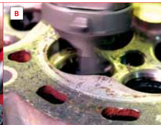
Достаточно попасть пилотом в отверстие направляющей втулки, включить на несколько секунд сферическую и малую плоскую воздушные подушки (а), затем установить скорость вращения шпинделя (б), чтобы начать обработку седла (в).
