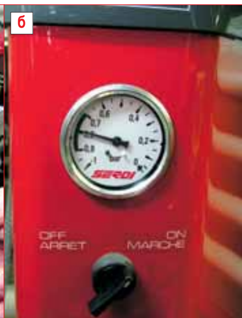
Для контроля плотности посадки клапана в седле служит вакуумтестер — необходимо установить клапан на место, поднести к отверстию канала насадку (а) и прочитать показания прибора (б).
