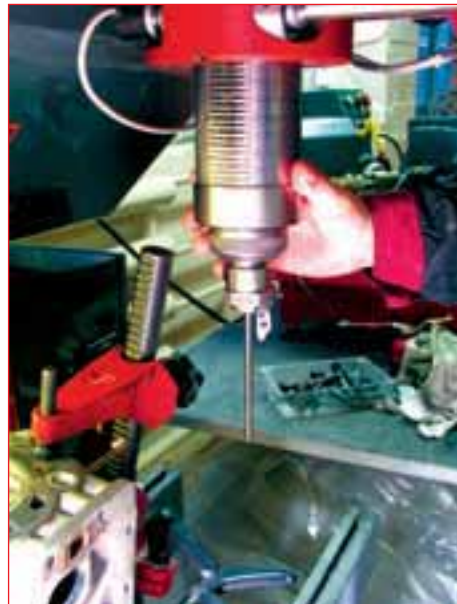
Узел крепления инструмента в станках SERDI — предельная жесткость и точная обработка всего профиля седла фасонным мультитупловым резцом.
