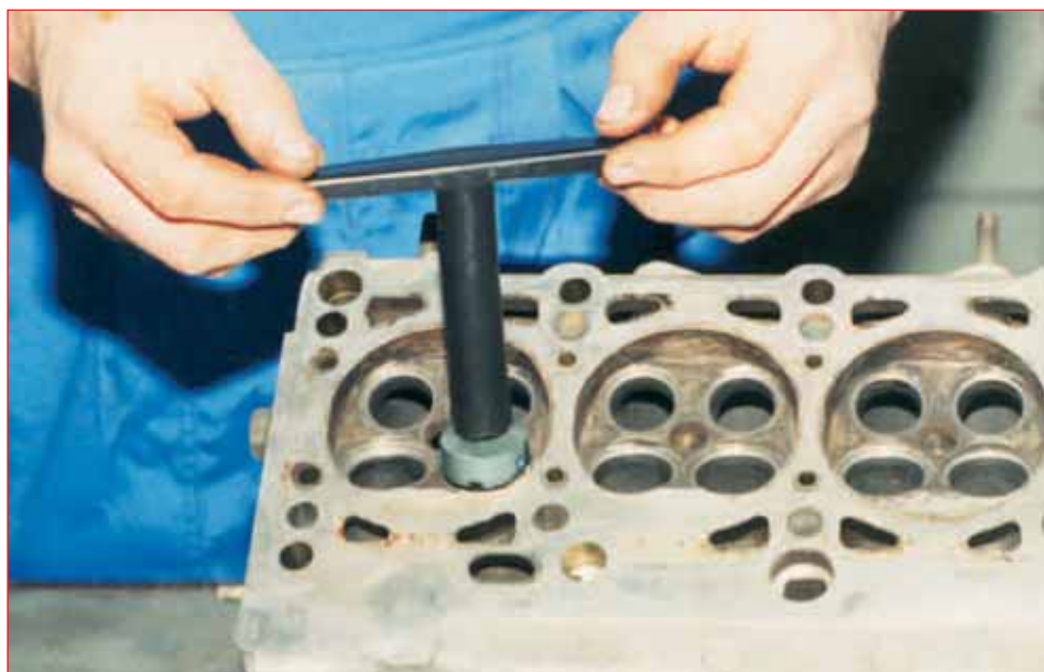
Ручной инструмент для ремонта седел — именно из-за него после ремонта клапанного механизма современных двигателей возникает немало дефектов.
