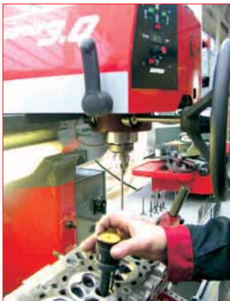
Объективно оценить качество обработки седла можно только путем прямого измерения его биения относительно отверстия направляющей втулки.
