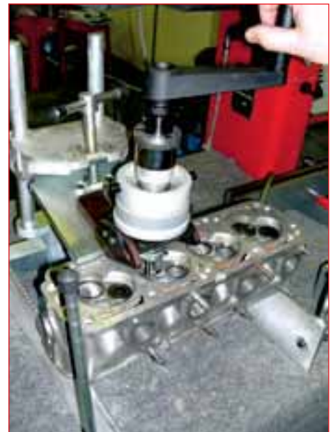
Портативная машина SERDI Micro — маленький аналог тройной воздушной подушки большого станка
