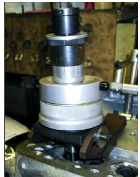
Рабочий узел SERDI MICRO позволяет быстро и точно обработать седло на любой головке блока.
