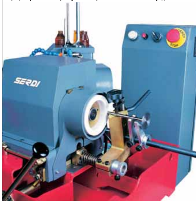
Торец стержня и его фаску HVR поправит за считанные секунды.
