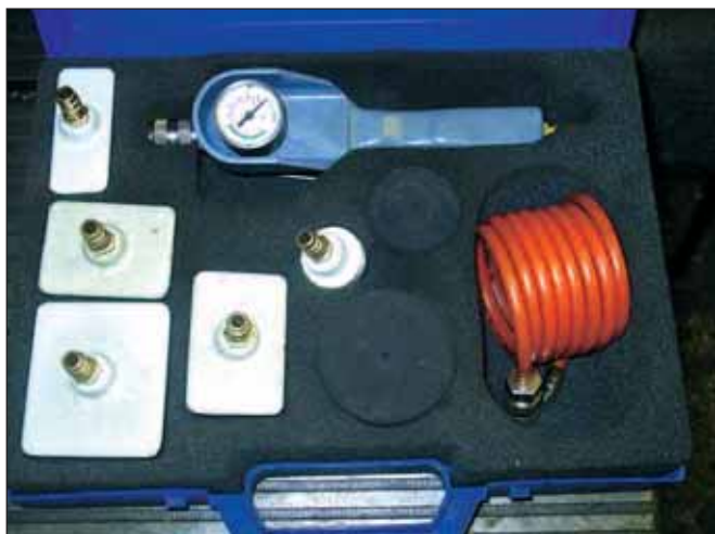
Вакуумтестер — неперенный элемент грамотной технологии ремонта ГБЦ.
