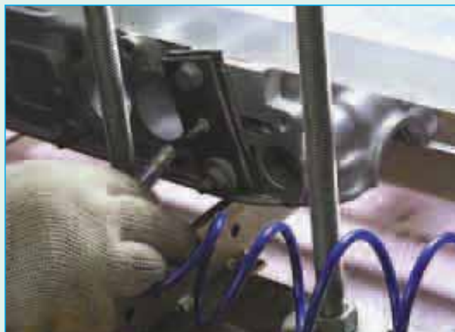
Сжатый воздух подается в полость головки через шланг с быстросъемным разъемом.
