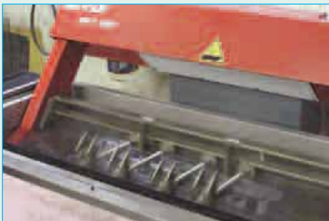
Исследуемый агрегат (в данном случае головку блока) можно автоматически вращать на 360°.
