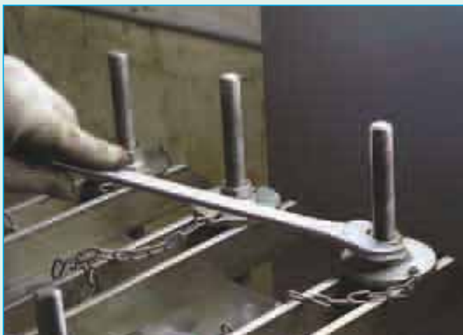
Плита надежно прижимается мощными струбцинами.
