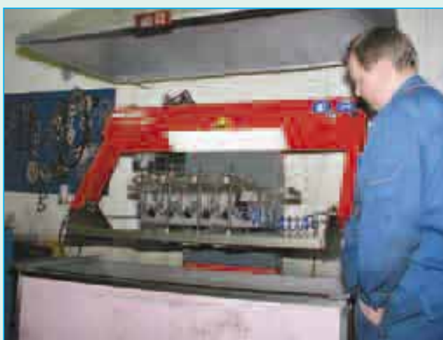
Не прошло и десяти минут, как к обследованию готов очередной объект — ГБЦ двигателя МВ.
