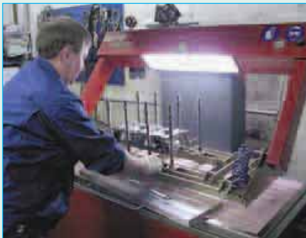
Работа начинается с установки ГБЦ на подвижную монтажную раму. Предварительно на отверстия рубашки охлаждения в боковой поверхности головки установлены заглушки, одна из них — со штуцером для подвода воздуха.
