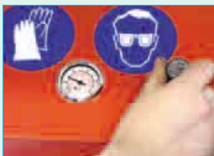
Установка снабжена вентилем и манометром для регулировки и контроля давления.
