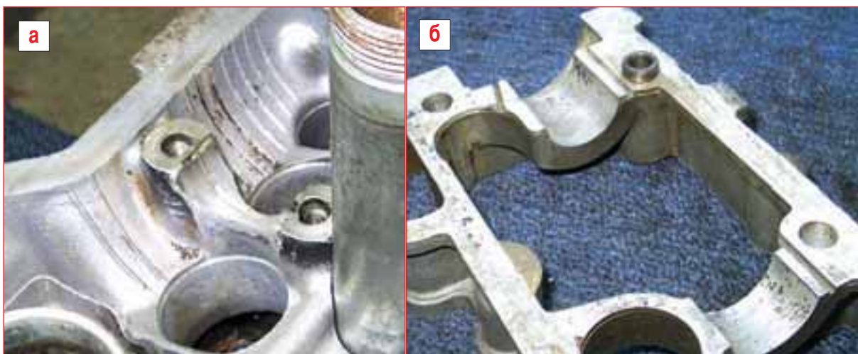
Постели распредвала от недостатка масла страдают не меньше, а чаще еще больше, чем сам вал. Но торопиться менять головку блока с поврежденными постелями на новую не стоит. (а и б)
