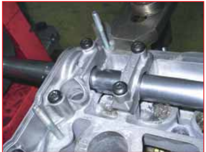
Постель растачивается в несколько проходов. Последний чистовой проход надо делать с минимальным припуском и подачей.
