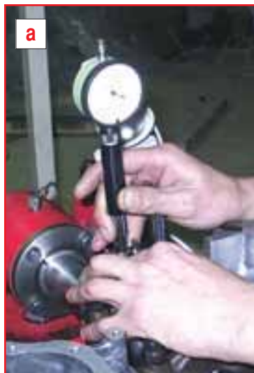
Очень удобный нутромер (а). С помощью ножек, вставляемых в зазор между борштангой и постелью (б), он позволяет контролировать полученный размер постели, что называется, «из-за угла», ничего не разбирая и не снимая со станка.
