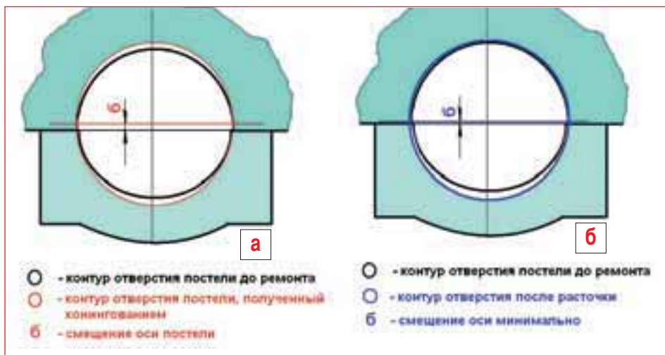
Схема обработки постели с «заниженной» крышкой — при хонинговании (а) ось постели сама займет некое среднее положение, а при расточке (б) положение оси может быть задано с учетом минимального припуска на блоке. В последнем случае смещение оси коленвала вверх будет контролируемым и минимальным, равным этому припуску. В первом случае все наоборот — контролировать смещение оси невозможно, и оно будет приблизительно равно половине общего припуска на обработку.
