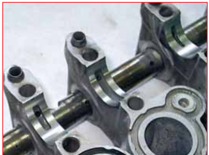
Качество поверхности после расточки не оставляет сомнений в возможностях этой технологии.
