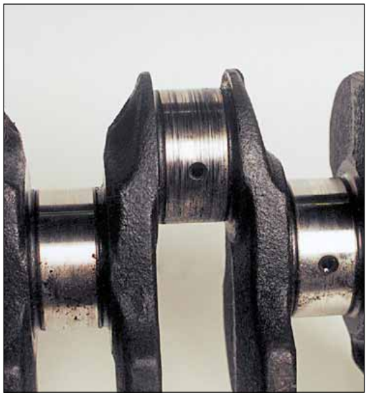
Задир на шатунной шейке — обычный результат работы вала при недостаточной смазке.
