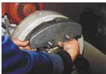
Балансировочные грузы подбираются для каждого вала
