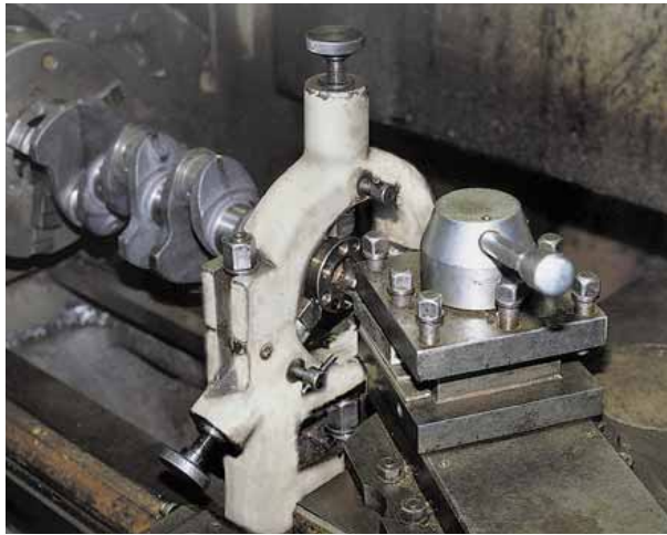
Если центровые фаски не обеспечивают правильной установки вала в центрах, их нетрудно проточить в токарном станке с помощью люнета.
