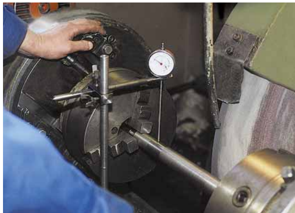
Непараллельность осей шатунных и коренных шеек непосредственно на валу не проверить, зато ее можно определить по несоосности патронов.
