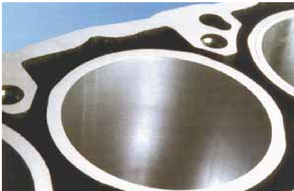
Цилиндры цельноалюминиевого блока не имеют никакого покрытия, что легко определяется не только по характерному серо-матовому цвету поверхности, но и ее «мягкости».
