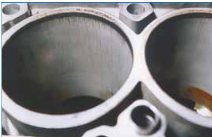
Типичные повреждения мягкого алюминиевого цилиндра при перегреве двигателя.
