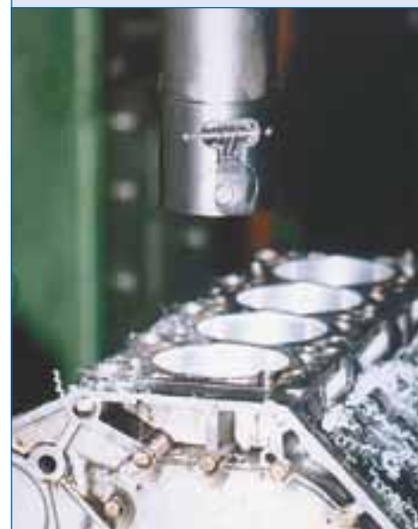
Расточка цилиндров алюминиевого блока — обычная ремонтная процедура.
