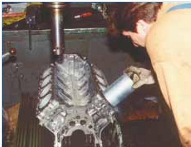
Самая ответственная операция для алюминиевой гильзы — поставить ее «от руки». Одно неверное движение — и гильза будет испорчена, а вся работа загублена.
