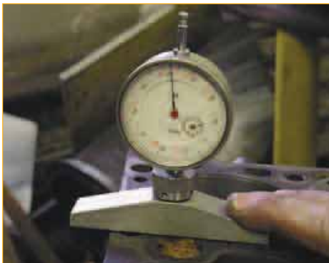
После выравнивания температуры деталей блока измеряется выступание гильзы и сравнивается с расчетной величиной, отмеченной в технологической карте. Если значения совпадают, можно двигаться дальше.
