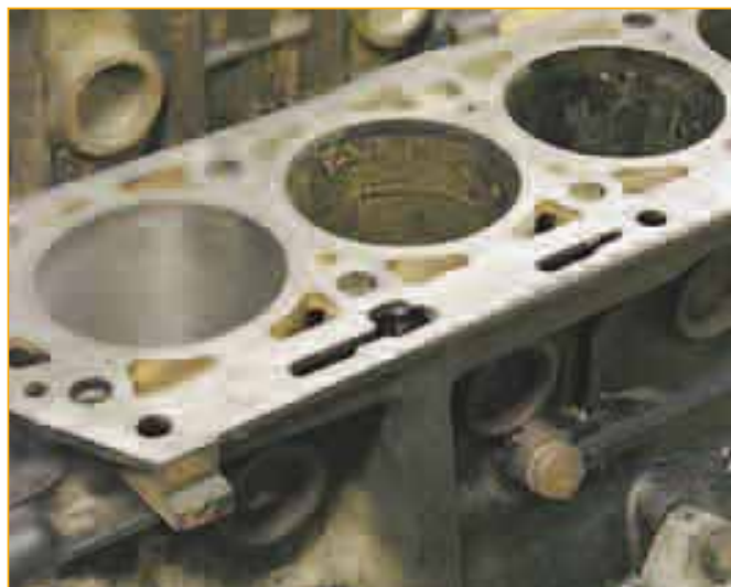
На обработанной привалочной плоскости использованного блока по периметру гильзы хорошо заметна кольцевая щель. На работоспособность двигателя она никакого влияния не оказывает.
