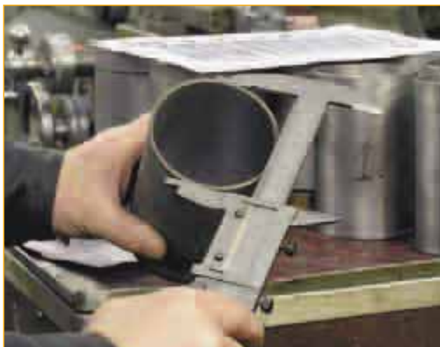
Изготовленные гильзы маркируются в соответствии с номерами цилиндров и тщательно обмеряются с занесением результатов в технологическую карту. Наружный диаметр упорного бурта должен быть таким, чтобы радиальный зазор ( \delta ) был не менее 0,2 мм.
