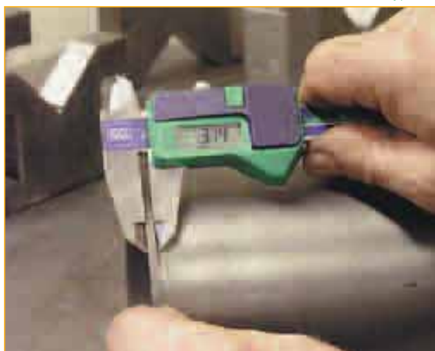
С такой же точностью необходимо измерить высоту упорного буртика.
