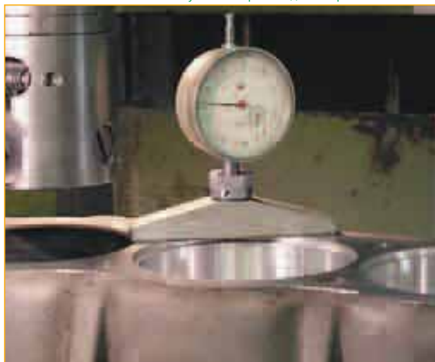
С такой же точностью необходимо измерить высоту упорного буртика.
