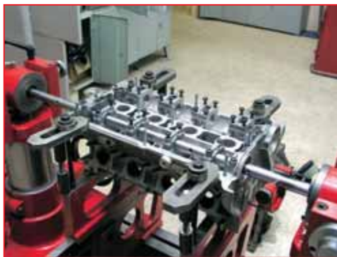
Теперь головка блока подготовлена к расточке.
