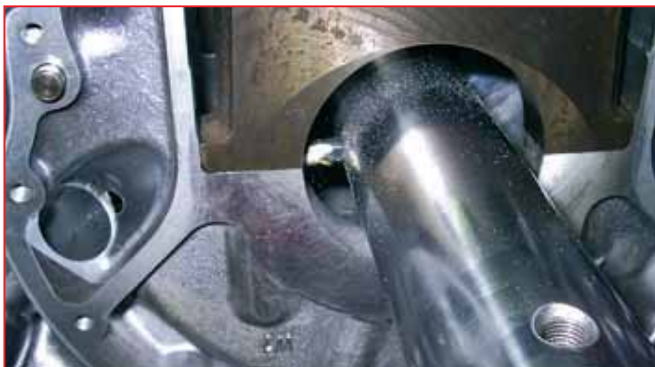
Качество гарантировано: последний чистовой проход одним резцом обеспечивает заданный размер, одинаковый на всех постелях блока.
