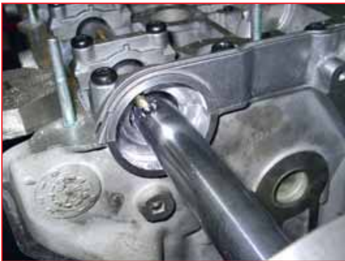
Завершающая операция — правка посадочной поверхности под сальник распревала. Без этого ремонт не будет качественным.
