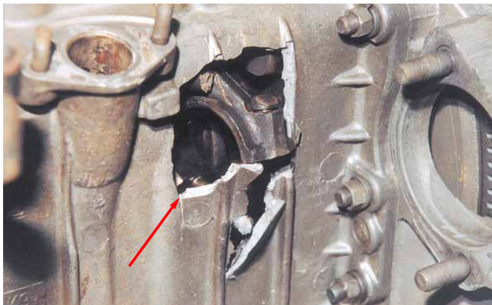
Разрушившийся шатун легко пробивает стенку любого блока цилиндров.
