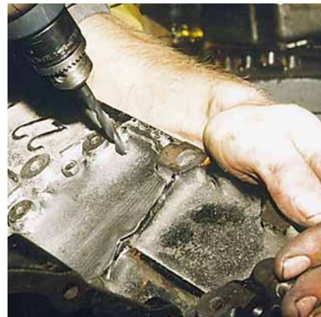
Далее сверлятся отверстия и нарезается резьба.
