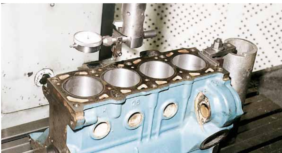
Расточка гнезд под гильзы выполняется на том же вертикально-расточном станке, что и традиционная расточка цилиндров.
