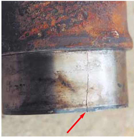
Из-за удара шатуна на гильзе образовалась трещина.
