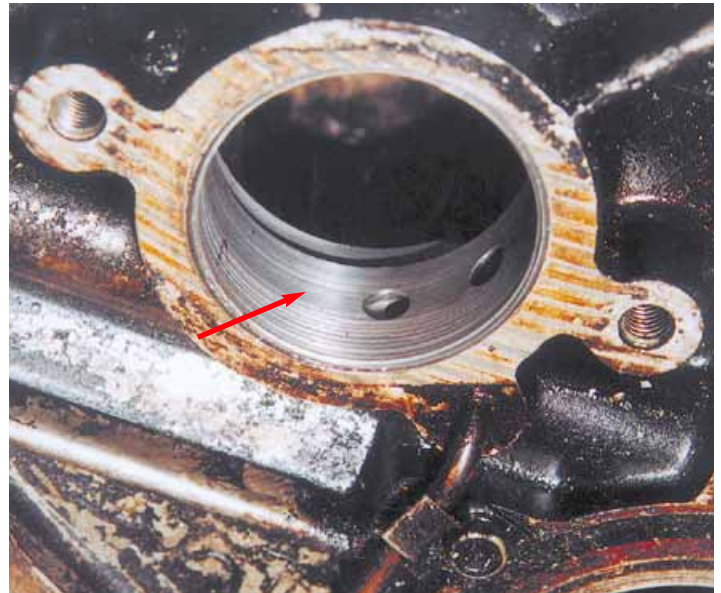
После большого пробега износ подшипников распредвала — обычное дело.
