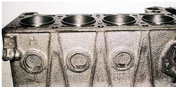
Расточка гнезд под гильзы выполняется на том же вертикально-расточном станке, что и традиционная расточка цилиндров.
