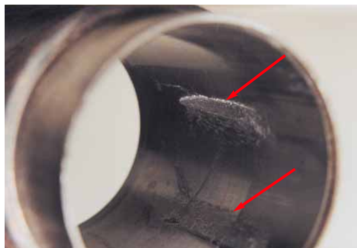
Задиры на поверхности цилиндра — обычный результат разрушения шатуна и поршня.
