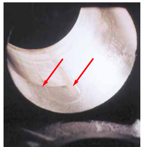
Когда посадка поршневого пальца в шатуне ослабла, палец сместился в сторону и «прогрыз» на цилиндре две глубоких борозды.
