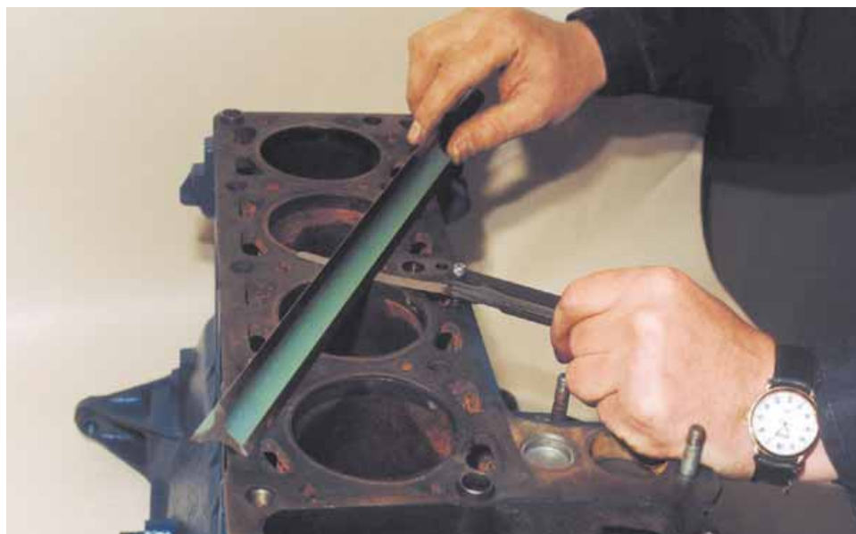
На старом блоке почти всегда обнаруживается деформация плоскости.
