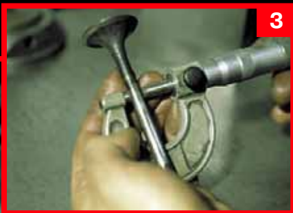
3. Для определения износа стержня клапана удобно пользоваться микрометром
