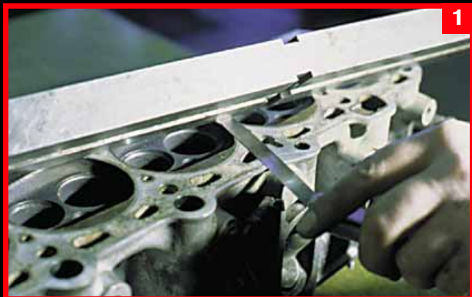
1. Лекальная линейка и щуп — самый простой способ проверки деформации плоскости головки
