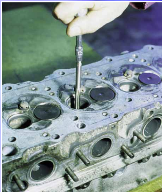
Обработывая отверстие втулки разверткой, не следует стремиться к малым зазорам со стержнем клапана, иначе впоследствии клапан может заклинить во втулке при работе двигателя
