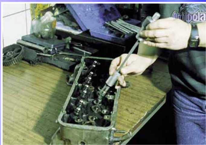
Снять маслоъемные колпачки удобно приспособлением с цанговым зажимом
