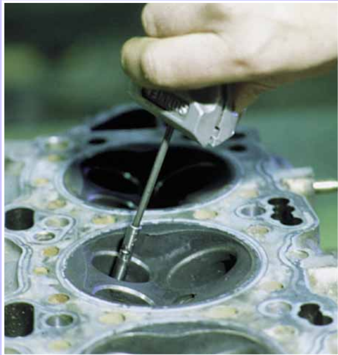
Если направляющая втулка изношена незначительно, ее можно отремонтировать, раскатав изнутри инструментом со специальным роликом
