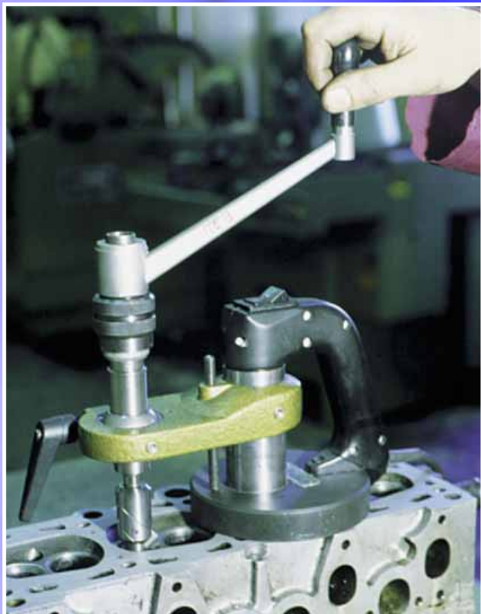
Специальное портативное приспособление с резцовой головкой практически исключает перекося седла
