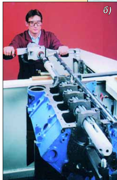
Специализированные станки для ремонта подшипников: а) расточной б) хонинговальный
