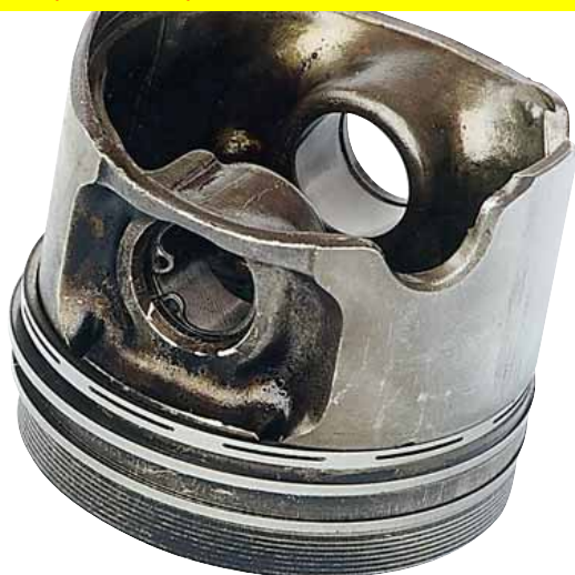
а) "родной" поршень имеет плавающий палец;
