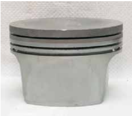
В 90-х годах поршни форсированных моторов обрабатывали гальваническим способом. Поверхности огневого пояса этого поршня анодированы.
