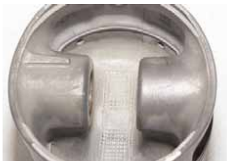
Начало 80-х, поршень двигателя Mercedes. Термокомпенсирующие прорези исчезли, уменьшилось расстояние между бобышками для крепления к шатуну с узкой верхней головкой.
