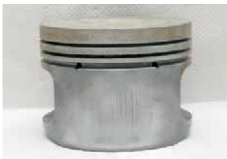
Начало 80-х, поршень двигателя Mercedes. Термокомпенсирующие прорези исчезли, уменьшилось расстояние между бобышками для крепления к шатуну с узкой верхней головкой.
