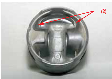
К концу 80-х в облике поршней становятся заметны «холодильники» (1) и вертикальные ребра (2), придающие юбке поршня жесткость.
