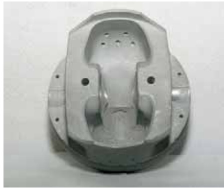
Топ-версия современного спортивного поршня. Ярко выраженная Т-образная форма, два поршневых кольца, предельно жесткая юбка с отверстиями для подачи масла.
