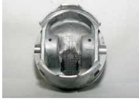
Изделие начала 90-х. Канавки поршневых колец становятся уже, высота поршня уменьшается.
