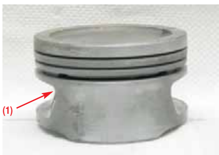
Начало 80-х, поршень двигателя Mercedes. Термокомпенсирующие прорези исчезли, уменьшилось расстояние между бобышками для крепления к шатуну с узкой верхней головкой.
