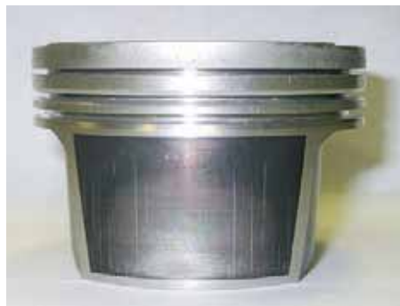
Поршень одной из уважаемых зарубежных фирм. Несмотря на антифрикционное покрытие, после 120 000 км пробега произошел сильный износ поверхности юбки на ненагруженной стороне (слева). Причина — отсутствие конструктивных мер для подачи смазки в зону трения при движении поршня вверх. Как говорится, «и на старуху бывает проруха».
