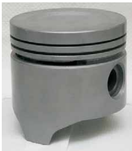
Поршень мотора Audi разработки 70-х годов. Термокомпенсирующий паз стал уже и переместился в канавку маслосъемного кольца. В конструкции также используются стальные термокомпенсирующие пластины. Заметна тенденция уменьшения высоты поршня.
