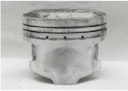
Изделие начала 90-х. Канавки поршневых колец становятся уже, высота поршня уменьшается.
