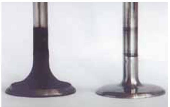
Доработанный впускной клапан — его тарелка стала вдвое тоньше.
