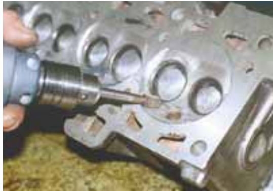
Помимо фрезеровки камера сгорания доводится вручную.
