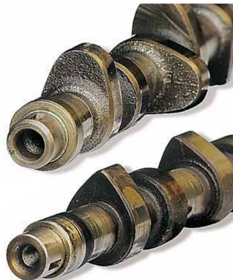
Кулачок распределительного вала для двигателя «Формула-1600» (вверху) намного полнее, чем у обычного распредвала (внизу).
