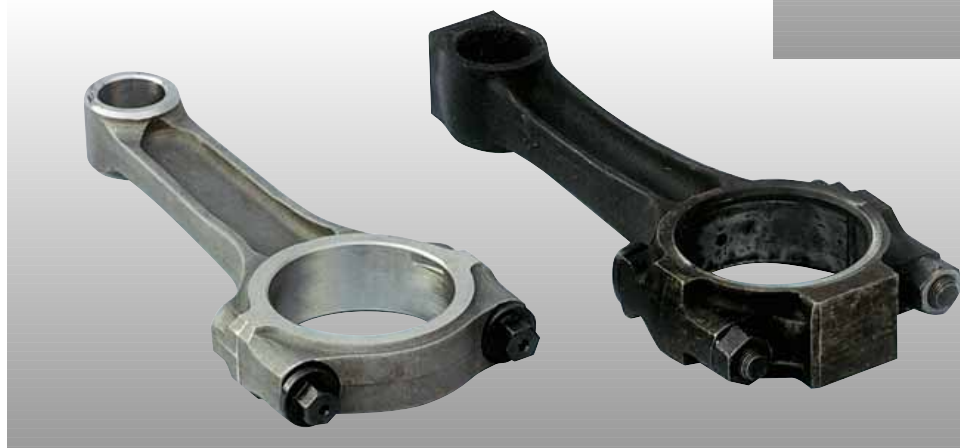
Шатун гоночного мотора (слева) намного легче и тоньше стандартного (справа), но его прочность при этом больше.
