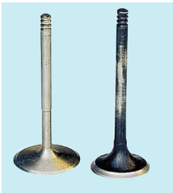
«Спортивный» клапан (слева) имеет более тонкий стержень, а его тарелка больше, чем у стандартного клапана (справа).
