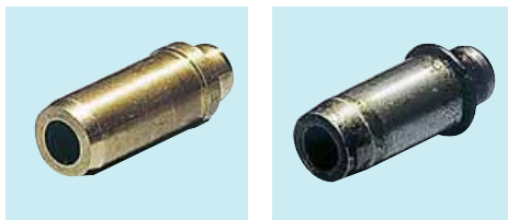
В отличие от стандартных направляющих втулок (справа) бронзовые втулки (слева) не ломаются и лучше отводят тепло от нагретого клапана.
