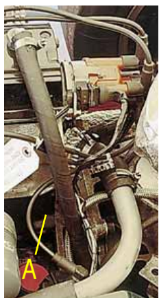
В этом двигателе VW для кольцевых гонок распределитель зажигания перенесен со штатного места на блоке (место А) на головку блока и не имеет центробежного и вакуумного автоматов.
