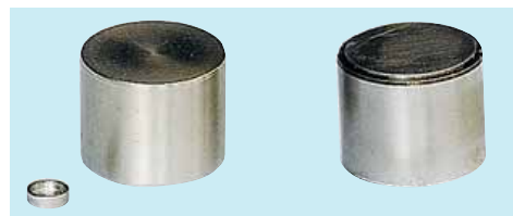
Для работы на больших частотах вращения регулировочная шайба ставится под толкатель (слева), а не на него, как в «стандартной» конструкции (справа).
