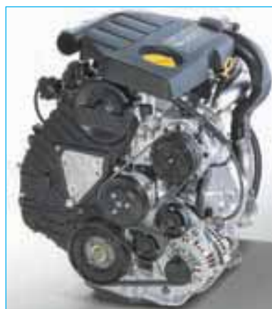
Так выглядит одна из последних разработок известного «дизелеведа», фирмы Isuzu, которая устанавливается на ряд моделей автомобилей, выпускаемых концерном GM. Турбодизель 1,7 CDTI с непосредственным впрыском топлива, осуществляемым системой Common Rail.
