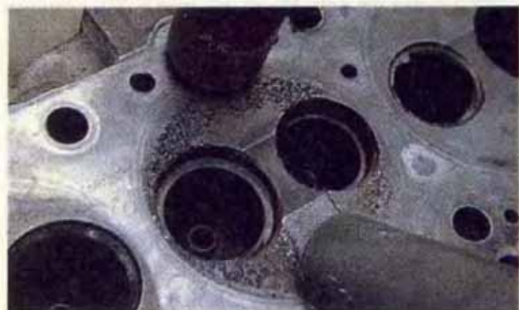
Фото 1. Мощные магниты установлены на головку цилиндров рядом с контролируемой поверхностью.
