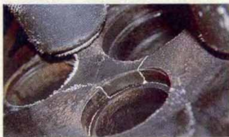
Фото 2. Сухой металлический порошок делает видимой скрытую трещину.
