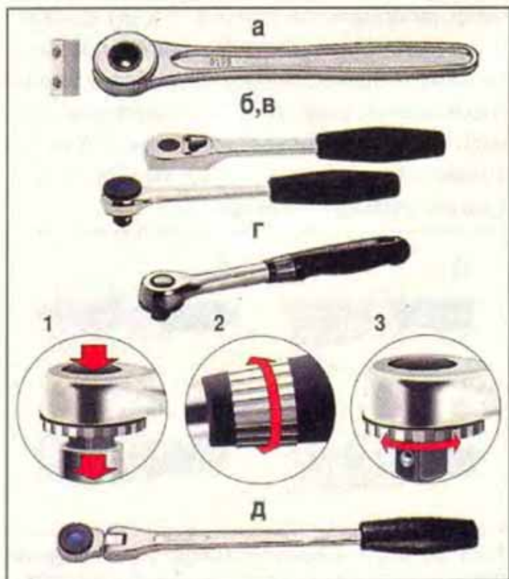
Рис.2. Приводы с встроенным храповым механизмом: а — перекидной (рядом показан необходимый для его применения переходник); б — реверсивный с кнопочным переключением; в — реверсивный с переключением кольцом; г — реверсивный эргономичный; д — реверсивный с шарниром; 1 — кнопка расфиксации; 2 — переключатель направления работы; 3 — кольцо для "доворачивания".
