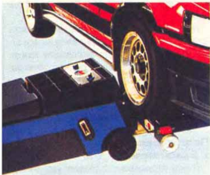
Фото. 1. Балансировка на передвижных стандах.
