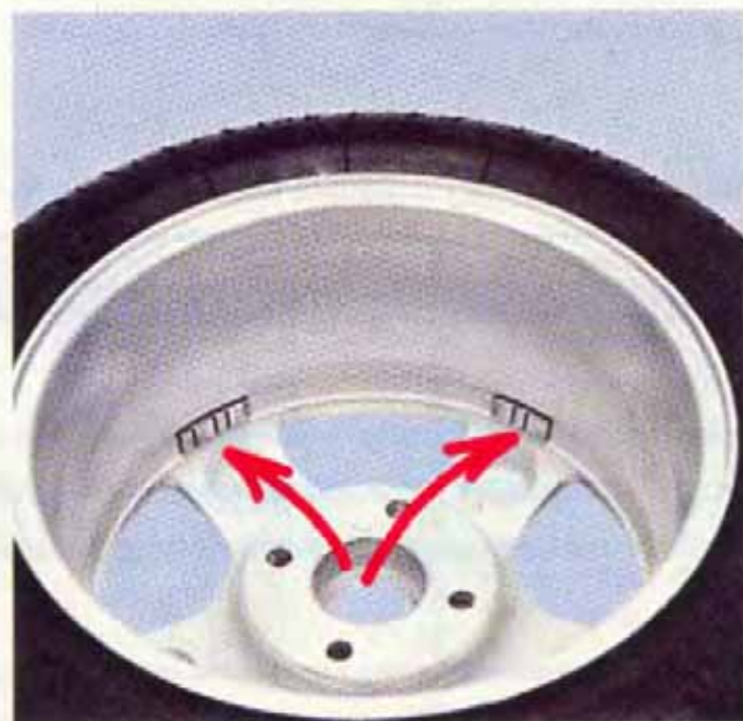
Фото. 3. Установка грузиков за спицами.
