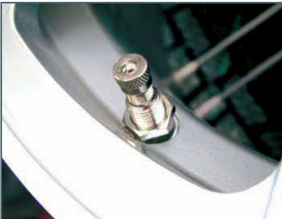
Металлический вентиль надежнее резинового.
