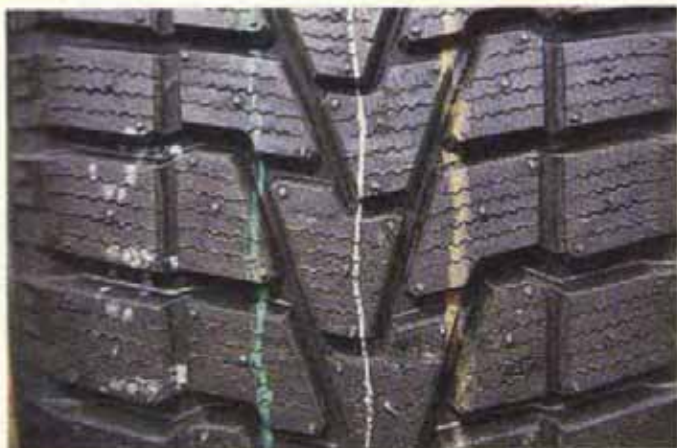
Фото 3. Европейский тип, направленный рисунок.
