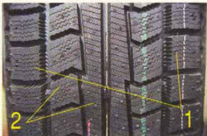
Фото 1. Европейский тип протектора: 1 — шашки; 2 — ламели.
