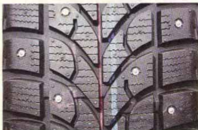
Фото 4. Европейский тип, 4 ряда шипов, направленный рисунок.
