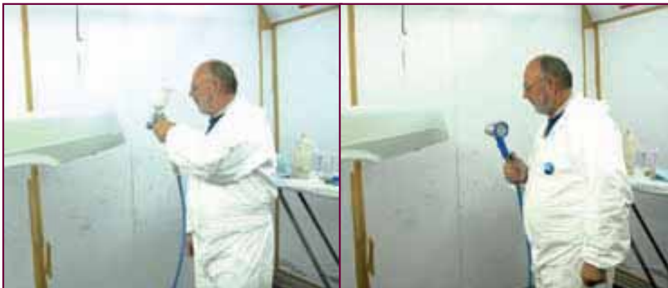
Окрашиваем зону ремонта (количество слоев — в нашем случае один — определил тест) и высушиваем ее.
