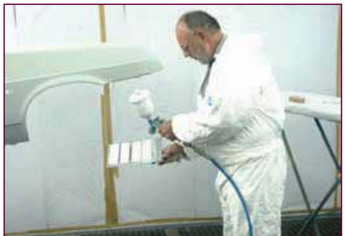
Сначала все пластины окрашиваем той же краской, которая будет использоваться в качестве первого слоя трехстадийной системы...
