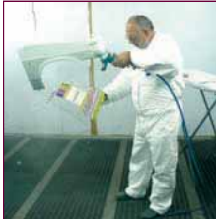
Каждую из трех пластин маскируем наполовину вертикально и наносим прозрачный лак.
