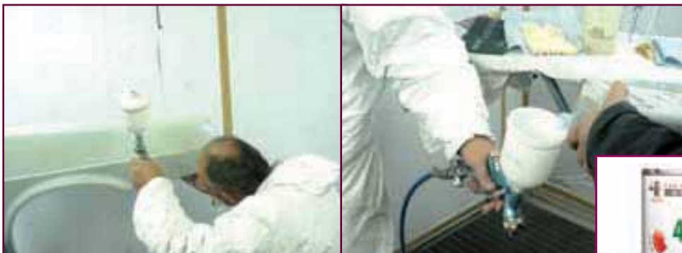
После покрытия лаком «размываем» границу старого и нового лака, используя растворитель для перехода.
