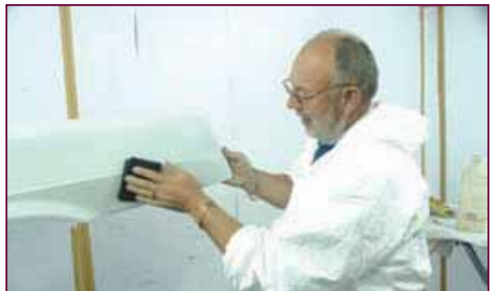
Ремонт покрытия начинаем с матирования поверхности детали скотч-брайтом.
