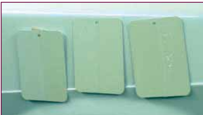
Сравниваем пластины с оригиналом и выбираем способ нанесения, при котором ремонтная краска повторяет цвет оригинального покрытия наиболее точно.
