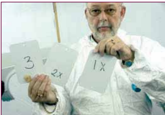
Прежде чем приступить к ремонту покрытия, нужно приготовить три одинаковые тест-пластины.
