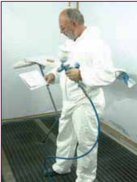
... затем первую тест-пластину полностью окрашиваем одним слоем перламутровой краски, вторую — двумя и третью тремя слоями.
