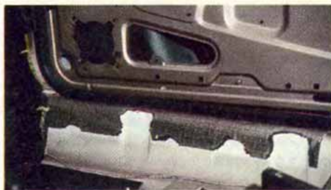
Фото 10. Частичное удаление заводских материалов.
