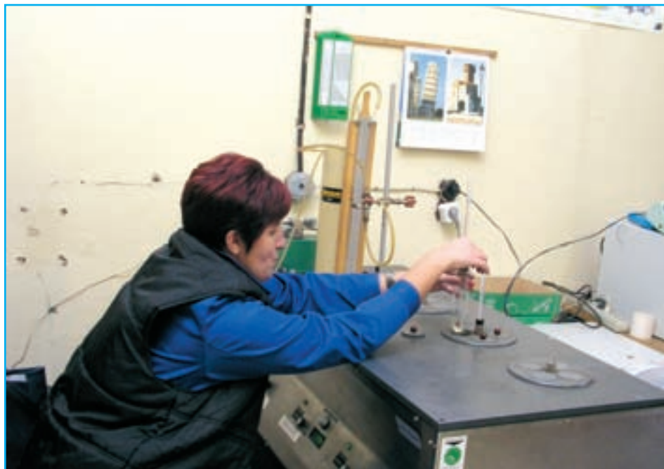
В тепловой бане определяют температуру, при которой дизельное топливо теряет прозрачность.
