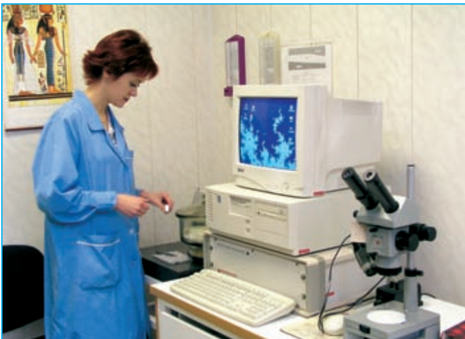
По результатам испытаний на этом приборе оценивают смазывающую способность топлива.
