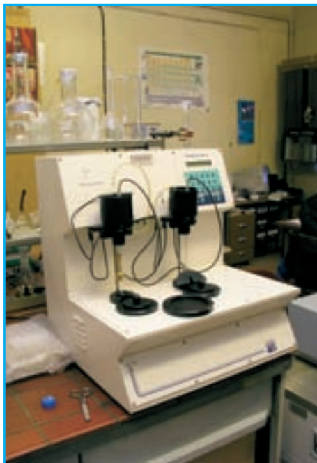
Прибор для определения предельной температуры фильтруемости
