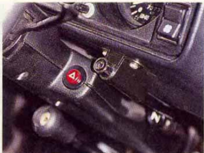
Фото 2. Запирающий механизм блокиратора капота
