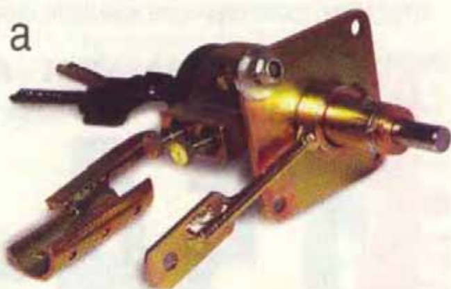
Фото 4. Блокиратор тяги КПП: а – комплект замка; б – установка замка.
