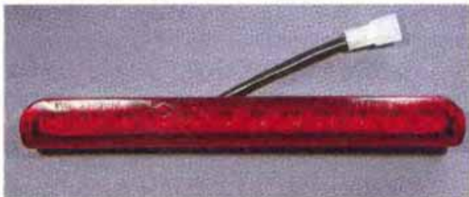
Фото 3. Дополнительный сигнал торможения на светодиодах.
