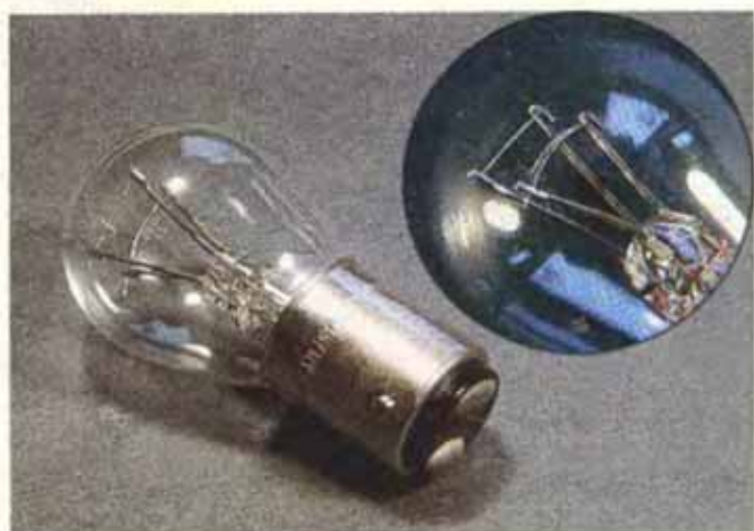
Фото 1. Двухнитевая лампа категории P21/5W.
